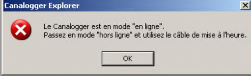
**Cliquer sur «OK», passer en mode «Hors ligne» et vérifier que le câble RS232 de mise à l'heure est connecté sur l'entrée CAN/COM de la centrale d'acquisition de données avant de reprendre la procédure.**
