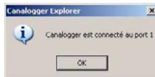
3 - Si la centrale d'acquisition de données n'est pas connectée, le message d'erreur suivant s'affiche :
